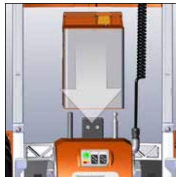
Akku-Pack aufsetzen. Akku-Pack rastet automatisch ein.
