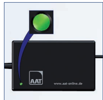
LED leuchtet grün = Akku vollständig geladen.
