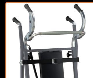
Auflagebügel Zum Transport von hohen Ladegütern. Einfache Montage mittels Klemmschellen an den Holmen der Handgriffe. Optimierte Lage und Schwerpunkt des Ladegutes für einfaches Handling.
