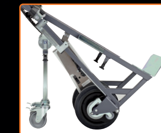
Transportrad Mit dem Transportrad können Lasten mit geringem Kraftaufwand auf der Ebene geschoben werden. Somit kann in Sekundenschnelle zwischen Treppensteigen und Rollen auf ebenem Gelände gewechselt werden. Auch höhere Lasten können hiermit durch Türöffnungen transportiert werden.
