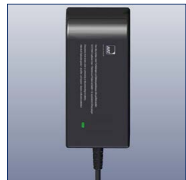
LED leuchtet grün = Akku vollständig geladen.
